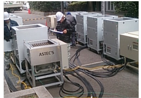
▲ 某データセンター・UPS（無停電電源装置）の能力検証
