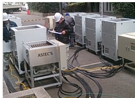
▲ 某データセンター・UPS（無停電電源装置）の能力検証
